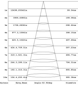
Note:Les courbes indiquent la zone éclairée et la moyenne d'éclairage lorsque le luminaire est à une distance différente
